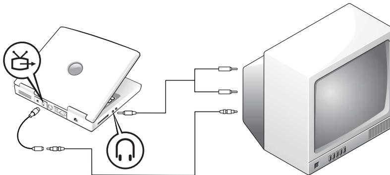
Per collegare il computer a un televisore dotato solo di ingresso video composito, utilizzare un cavo adattatore di uscita TV composito. Prima di iniziare, controllare di avere a disposizione i seguenti cavi:
