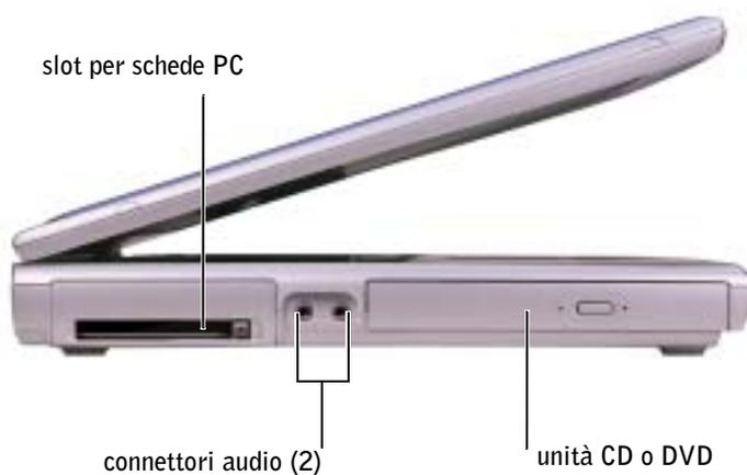
**SLOT DELLA SCHEDA PC** — Supporta una scheda PC, quale una scheda per modem o adattatore di rete. Per ulteriori informazioni, consultare "Utilizzo di schede PC" nel file della guida *Istruzioni e procedure*. Per accedere al file della guida, vedere pagina 78.
