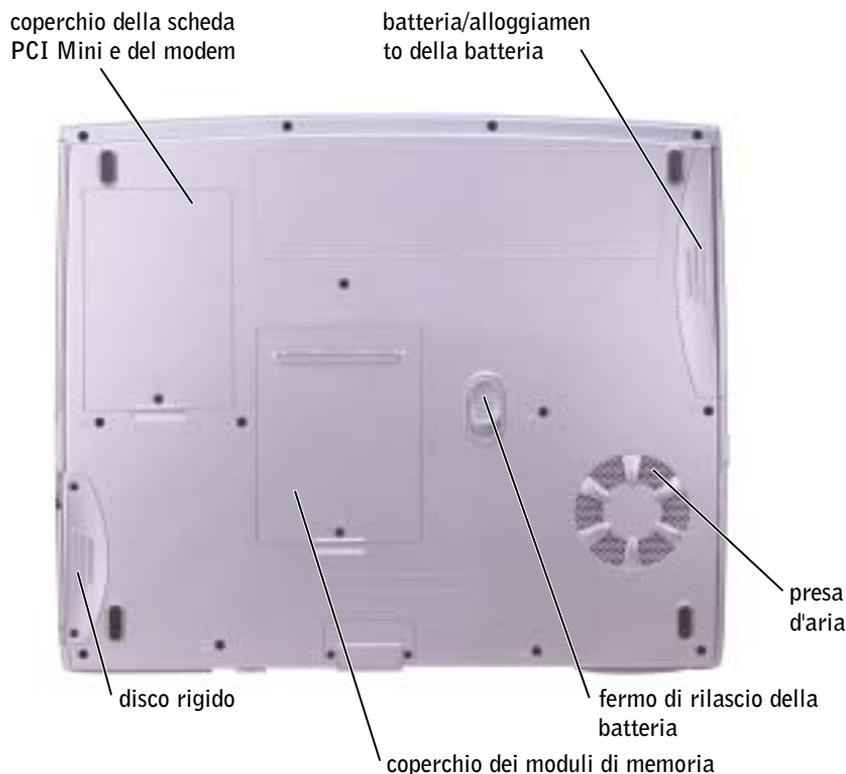
**COPERCHIO DELLA SCHEDA PCI MINI/MODEM** — Copre il compartimento che contiene la scheda PCI Mini e la scheda modem. Vedere pagina 102.
