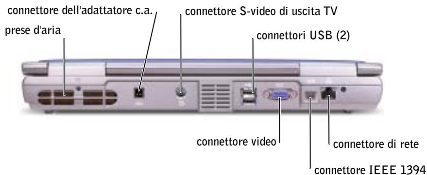
**PRESE D'ARIA** — Il computer usa una ventola interna per creare un flusso di aria attraverso le prese di ventilazione, in modo da prevenire il surriscaldamento.
