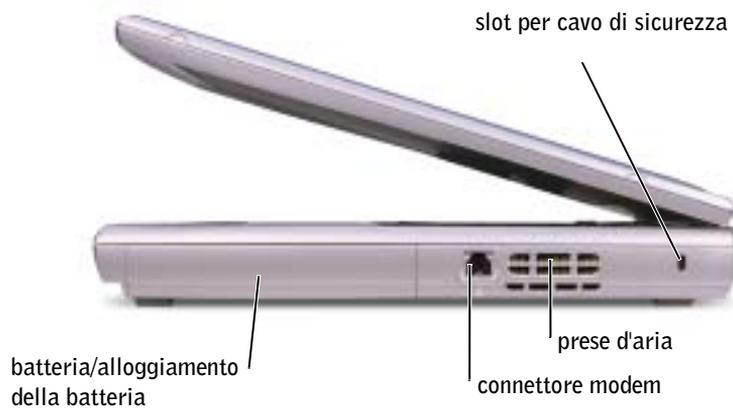
**BATTERIA/ALLOGGIAMENTO PER BATTERIA** — Se nell'alloggiamento è installata una batteria, è possibile usare il computer senza collegarlo a una presa elettrica. Vedere pagina 39.
