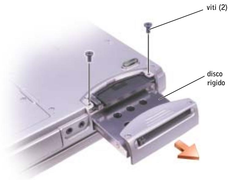
**AVVISO:** Quando il disco rigido non è inserito nel computer, riporlo in un involucro antistatico. Consultare "Protezione dalle scariche elettrostatiche" a pagina 15.
